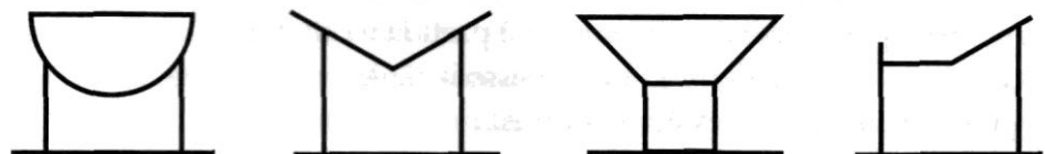
Formas de telhado que não apresentam inconvenientes
